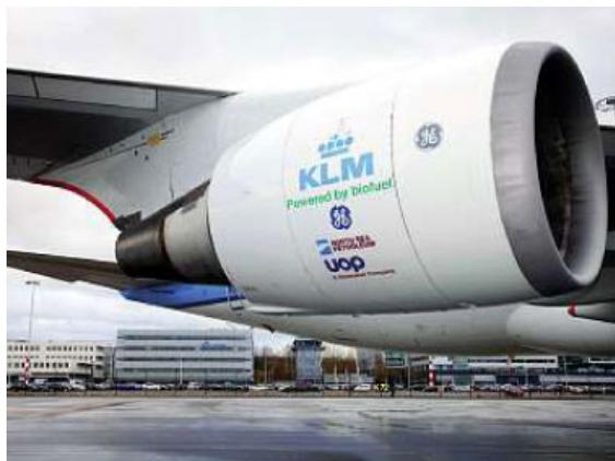
Letadlo KLM Boeing 747-400 se 23.listopadu 2009 stalo prvním komerčním strojem, jehož jeden motor GE 90 letěl na směs 50 % biokerosinu a 50 % kerosinu
